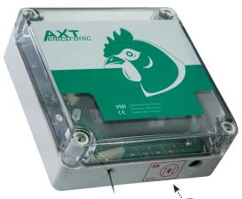
Einstellung der Lichtempfindlichkeit über Drehregler: z.B. 3 (oben) schließt abends früher, öffnet morgens später; drehen nach rechts = abends später schließen und morgens früher öffnen
